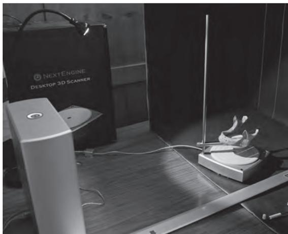
Fig. 4 – Feixes laser a incidirem sobre a mandíbula no processo de digitalização. O objeto é colocado sobre uma placa rotativa controlada pelo digitalizador (à esquerda).
