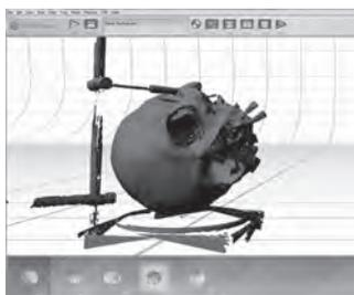
Fig. 5 – Modelo 3D obtido antes da remoção do material que não pertence ao crânio, sendo visível parte da placa rotativa e do braço metálico que sustenta o crânio na posição definida.
