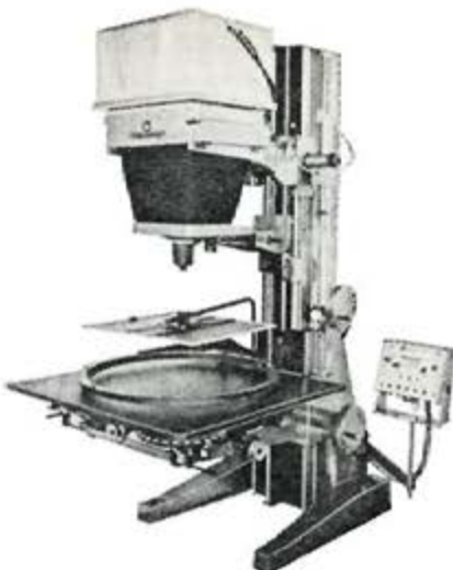
O novo amplificador modelo C-16 da Consolidated International, de máxima perfeição para reticular as seleções. O porta-tramas é rolante e o porta-filtros automático.
