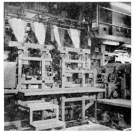
As saídas da rotativa são já em tiras que outro dispositivo cortará em fôlios soltos para serem conduzidos ao sector de acabamento.
