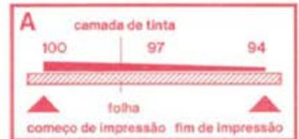
Acumulação de tinta no lado da pinça e diminuição de tinta para o fim da impressão, a partir de 100 para 94.
