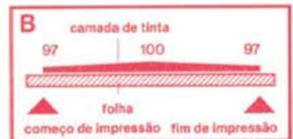
Por uma alteração do começo do movimento de vaivém obtém-se uma espessura igual da camada de tinta no começo e no fim de impressão.
