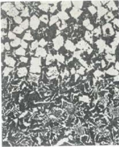
Fig. 4—A segregação de uma liga eutéctica. Os cristais primários (cúbicos) separam-se para cima durante a solidificação lenta, e as duas metades da amostra têm propriedades diferentes ( $\times 100$ ).
