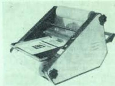
**Morane Document Laminator.** — Esta máquina rotativa de colagem por aquecimento, introduzida primeiramente no mercado em 1972, com filme em *polyester*, cola simultaneamente em ambos os lados do material impresso.
