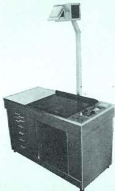
**Contactcolor** tipo 354 — Aparelho para separação directa das cores por contacto. Trata-se de um sistema completo e integrado, incluindo uma trama ou rede de vácuo para todos os fins, fonte luminosa pontual e controlador de exposição colocado num gabinete adequado.
