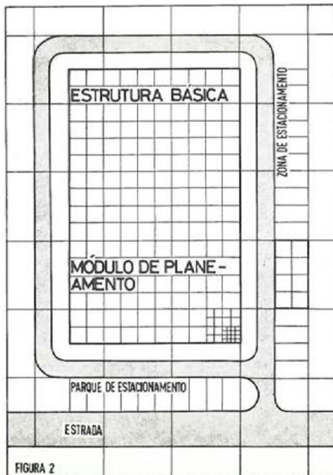
É essencial, nesta fase da planificação, que se desenvolvam muitas alternativas que possam depois ser usadas paralelamente. Mais tarde essas alternativas podem avaliar-se para melhorar a solução. A fig. 2 é um desenho esquemático de uma das alternativas. Mostra-nos as fases de aumento, espaço para estacionamento, módulos básicos, grelha de planificação e área máxima a ser utilizada. Não são dados quaisquer pormenores quanto à 1.ª fase do edifício.
