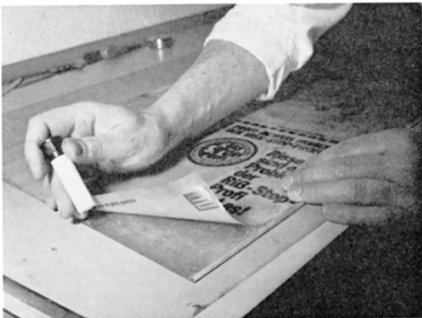
A imagem mostra a colagem do alceamento, feito em material *Nyloprint ZF24*, nas costas de uma chapa *Nyloprint*. A película *ZF24* é insulada com o mesmo negativo que serviu para a chapa e é absolutamente estável.
