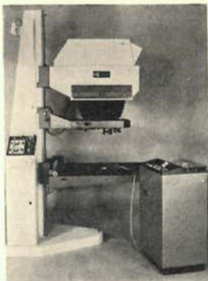
Câmara para selecção de cores «Hohlux Selectron»
