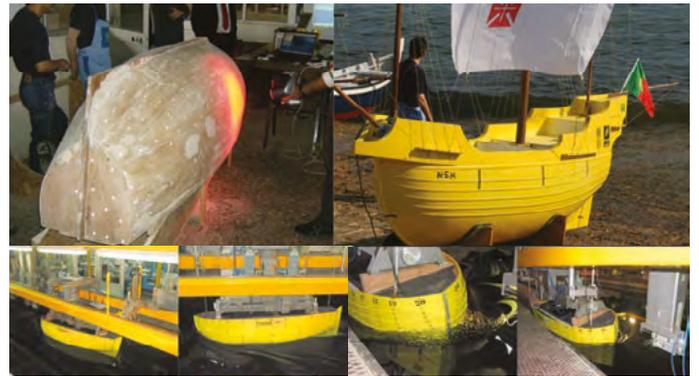
Fig. 16 – Modelo construído para os testes efetuados em tanque de ensaios (© Nuno Fonseca).
