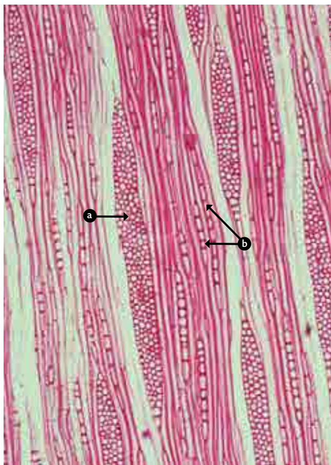
FIGURA 87 Parênquima lenhoso unisseriado (a) e plurisseriado (b) em corte tangencial de Ilex aquifolium (Aquifoliaceae). N.b.: comparar com Figura 85. [Curtis et al. (2002).]
