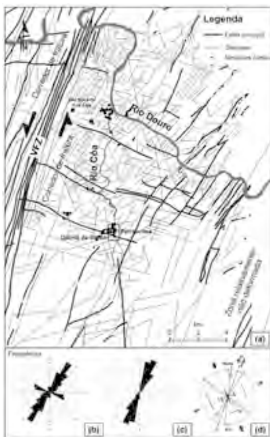
Fig. 2 – Mapa de alinhamentos na área de estudo detetados a partir da análise de imagens de satélite e complementados por trabalho de campo. VFZ = Zona de falha da Vilaríça (a); diagrama de roseta com classes de intervalos de 10 graus e uma população de 705 mostrando a distribuição estatística da frequência da orientação dos alinhamentos da área de estudo (b); diagrama de roseta com classes de intervalos de 10 graus e uma população de 200 mostrando a distribuição estatística da frequência da orientação dos alinhamentos da área da Quinta da Barca/Penascosa (c); organização das estruturas associadas a um corredor de deslize esquerdo com direção NNE-SSW (a VFZ) para a área de estudo. R = fraturas riedel sintéticas; R1 = fraturas riedel antitéticas; N = falhas normais; F = eixo de dobra; RF = falhas inversas; P = fraturas riedel sintéticas secundárias; T = fraturas de tensão; setas negras curtas = sigma 1 (eixo de compressão máxima); setas cinzentas curtas = sigma 3 (eixo de distensão máxima) (d) (modificado a partir de Aubry, Luís e Dimuccio, 2012).
